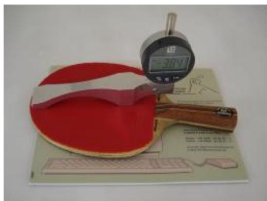
Die Anzeige der Messung erfolgt auf 100stel Millimeter genau, also z.B. -3,84 mm. Das bedeutet, dass der Belag eine Gesamtstärke von 3,84 mm aufweist.
