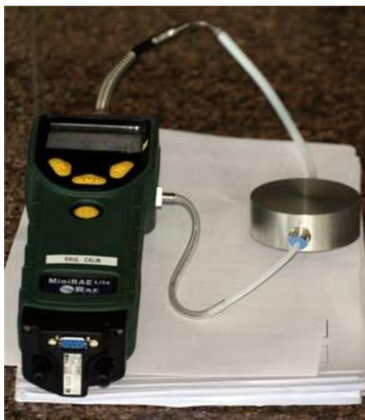
einen Schlägerbelag gesetzt und das Messergebnis nach 20 Sekunden abgelesen (z.B. 3,5 ppm). Die Differenz zum vorher gemessenen Grundwert ist als reales Ergebnis der Belastung durch lösungshaltige Stoffe des Belages zu notieren (im Beispiel:  $3,5 - 1,2 = 2,3$  ppm).
